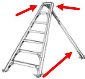
Sur une pente, placer la perche directement vers le haut à un angle de 90 degrés
